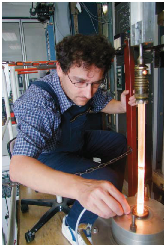
Obr. 7 Preforma optického vlákna zasunutá do grafitové pece v nejhorkější části jedné ze dvou tažících věží pro přípravu experimentálních optických vláken v ÚFE.
