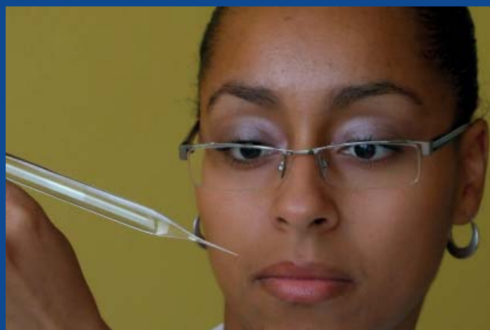
Obr. 8 Preforma přecházející do optického vlákna při tažení.
