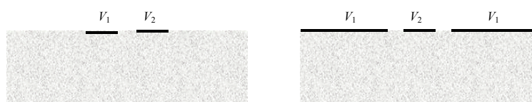
Obr. 9. Symetrické dvou vodičové a tří vodičové koplanární vedení.
