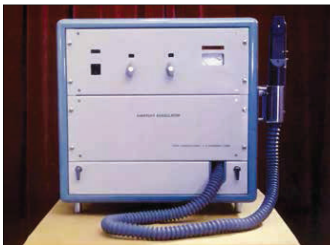
Obr. 3 Kvantový koagulátor pro laserovou operaci sítnice. Byl realizován v ÚŘE ČSAV a úspěšně otestován v kooperaci s MUDr. J. Johnem v nemocnici na Bulovce
