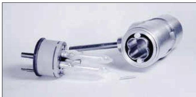
Obr. 4 Rubínový laser v rozloženém stavu: mezi výbojky se uchycuje rubínový krystal (tyčinka v popředí), čtyřeliptická dutina se použila k dosažení vyšší účinnosti čerpacího záření (květen 1963)
