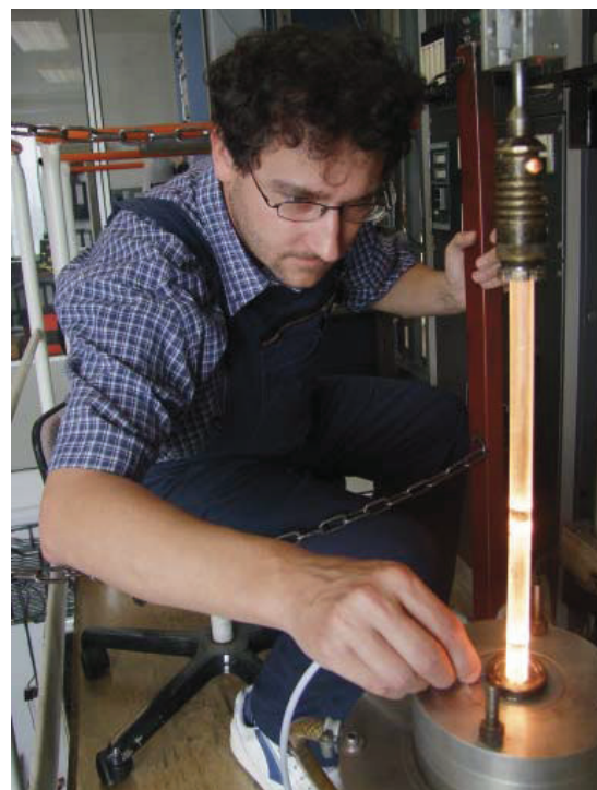
Obr. 6. Preforma optického vlákna zasunutá do grafitové pece v nehořejší části jedné ze dvou tažících věží pro přípravu experimentálních optických vláken v ÚFE.
