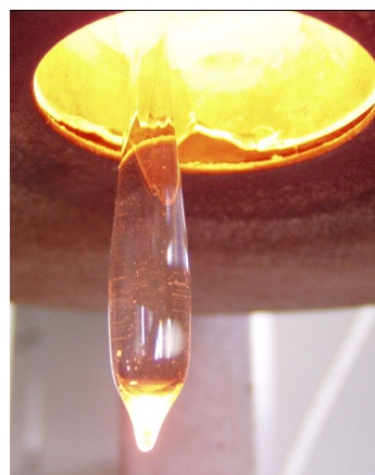
grafitová pec, pohled zdola, odkapávající část preformy
