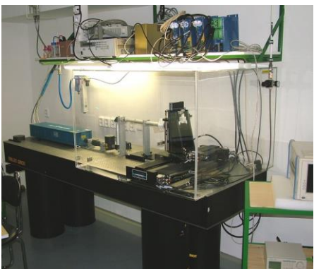
Aparatura s CO 2 laserem pro zápis LPG vláknových mřížek v ÚFE Kobylysy.
