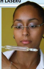
■ Skleněná „preforma“ dvouplášťového optického vlákna
