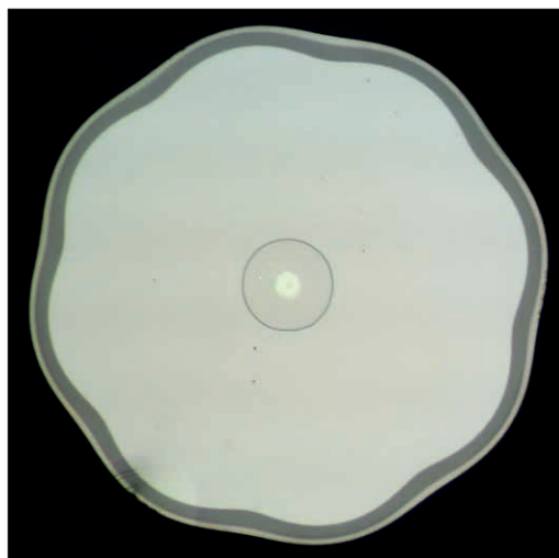
Obr. 2 Optické vlákno s kompozitním pláštěm připravené pro mezinárodní projekt TALOS. Legenda: vnější vrstva pláště – fluorovaný oxid křemičitý; vnitřní plášť – oxid křemičitý; jádro vlákna dopované thuliem je obklopeno prstencovým obalem (tzv. podstavec – pedestal) s indexem lomu vyšším než je index lomu oxidu křemičitého. Vnější průměr vlákna: 445 \mu\text{m} .
