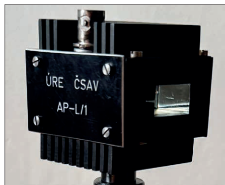
Obr. 3 Realizovaný vzorek akustooptického deflektoru. Technické parametry: Optická apertura: ~ 20 mm × 5 mm; AO medium: těžké flintové sklo SCHOTT SF4; Piezoelektrické měniče: řez 163°Y \text{LiNbO}_3 ; Studená difúze Au-Sn/Sn-Au; Akustický absorbér: slitina In-Sn; Frekvenční pásmo: 50 MHz – 100 MHz; VF příkon: 1 W – 2 W; Elektrická vstupní impedance: ~ 50 Ω; Počet rozlišitelných bodů (Rayleighovo kritérium): 256; Difrakční účinnost @ 488 nm: > 60 %.
