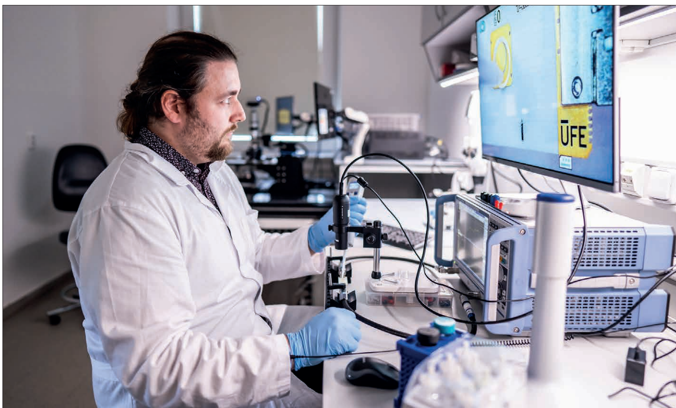
Obr. 1 Výzkumník z týmu Bioelektrodynamiky kontroluje mikrovlnný čip pomocí flexibilního optického mikroskopu, přičemž na velkém monitoru sleduje zvětšený obraz mikrostruktur čipu. Mikrovlnné čipy, které tým vyvíjí, bývají často kombinovány s mikrofluidními prvky a plní jednu ze dvou funkcí: slouží buď jako senzory složení a dynamiky biologických vzorků, nebo k cílené aplikaci elektromagnetických polí do biomolekulárních struktur a buněk.
