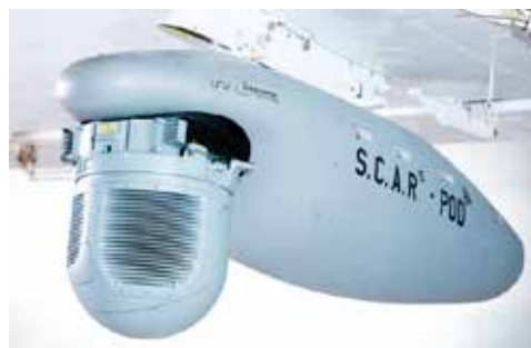
podvěsný kontejner s radiolokátorem i-Master se schopností SAR
