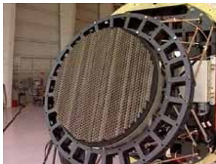
kompletní AESA anténa AN/APG-81
