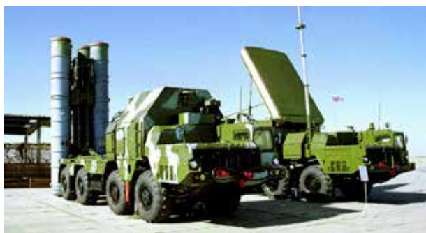
protiletadlový systém S-300PM (1985) v kódu NATO SA-10d odpalovací zařízení + radiolokační vozidlo výškový dosah: 25 – 27 000 m dálkový dosah: 5 - 90 km
