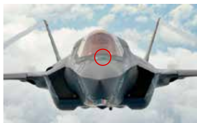
jeden dopředný DAS pro přední polosféru před pilotní kabinou
