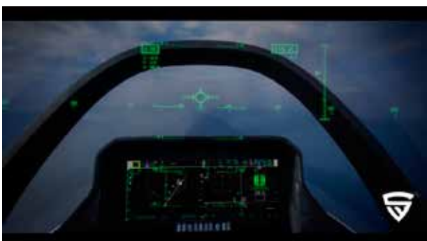
scéna bez vizuálního situačního systému DAS, HUD je vysvícen na zorníku, je vidět kokpit a konstrukci draku
