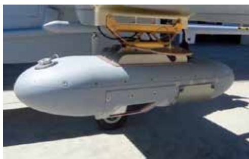
podvěsný kontejner se senzorem WAMI RedKit se schopností IMINT/GEOINT
