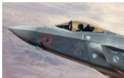
dva stranové DAS (jeden vpravo, druhý vlevo) pod pilotní kabinou
