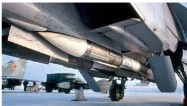
protiletadlová řízená střela R-37 dalekého dosahu s aktivním radiolokačním naváděním (na Mig-31)
