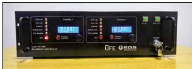
Obr. 6 Širokopásmový thuliový ASE zdroj záření s šířkou pásma ( -20 dB) > 240 nm s thuliovým vláknem vyvinutým v ÚFE
