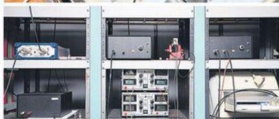
Dva černé přístroje vpravo nahoře jsou tzv. BVA oscilátory.
