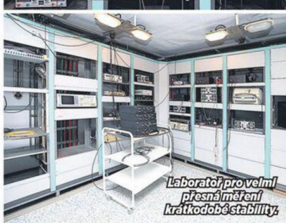
Dva černé přístroje vpravo nahoře jsou tzv. BVA oscilátory.
